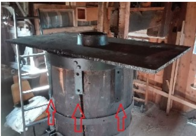
Bild 8: an den eisernen Zapfen angeschweißte Klauen
